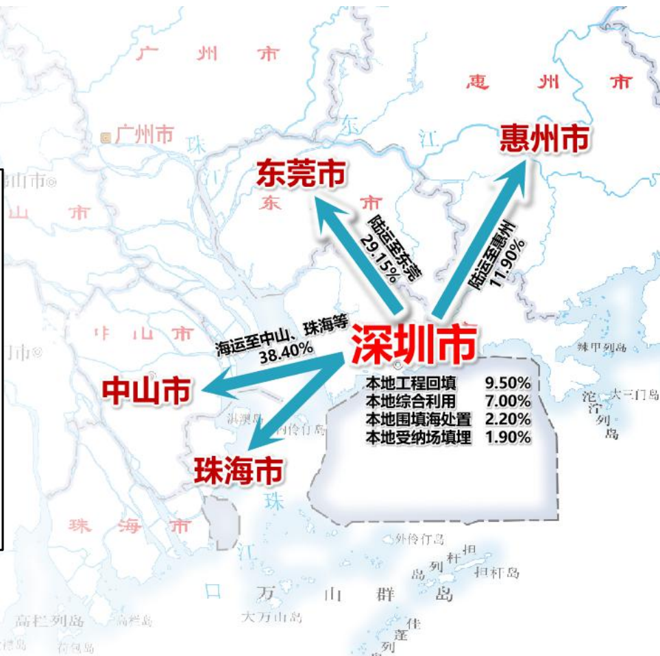
2018年深圳市建筑垃圾处置去向
