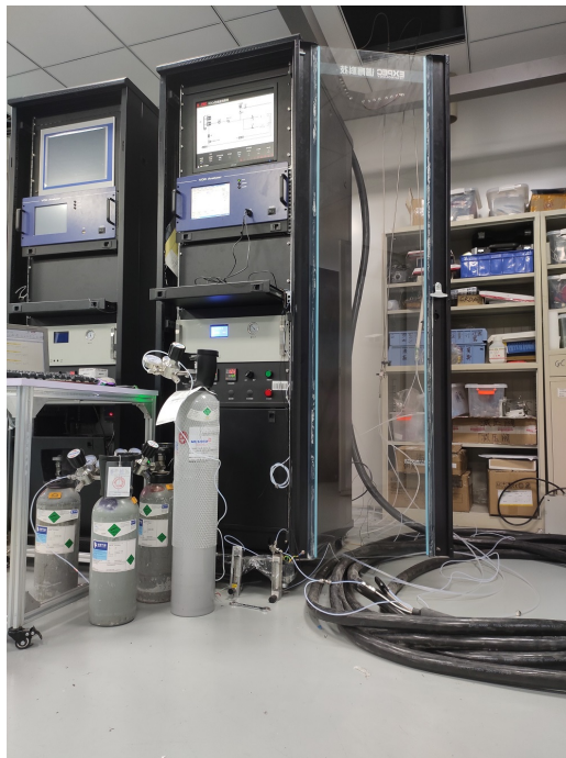
附图 1-2 辛烷经伴热管进仪表测试
